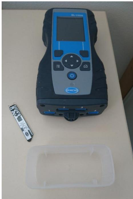
Figure 12: Appareil de mesure Hach® SL1000 et Chemkey
